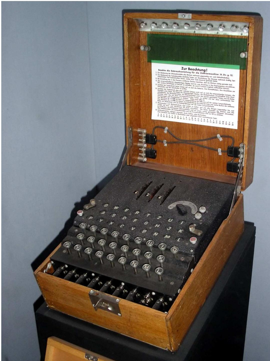
dadurch, daß mit dem jeweiligen Tagesschlüssel nur ein speziell für die folgende Nachricht gültiger zufällig gewählter Schlüssel übermittelt wurde; danach wurde die Maschine gemäß diesem Schlüssel in eine
