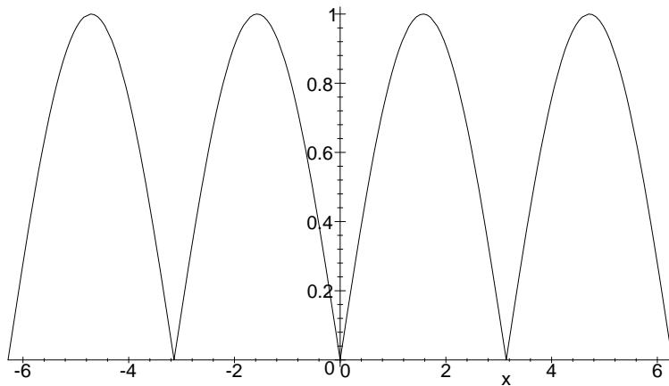
Da  $|\sin t|$  im Intervall  $[\pi, 2\pi]$  genauso aussieht wie in  $[0, \pi]$ , ist  $f(t)$  bereits periodisch zur Periode  $\pi$ ; die zugehörige Kreisfrequenz ist somit  $\omega = \frac{2\pi}{\pi} = 2$ .
