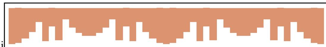
Die obige Abbildung zeigt den Querschnitt über ein solches Phasengitter, hier für  $p = 23$ . Entsprechende SCHROEDER-Reflektoren zu den verschiedensten Primzahlen gibt es in vielen Konzertsälen und Opernhäusern, oft allerdings verborgen hinter schalldurchlässigem Material.
